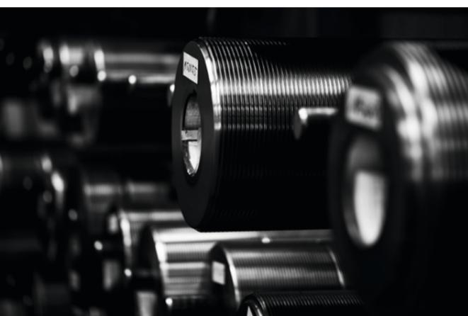
≡ **Gewindetechnik:** Wir fertigen unterschiedlichste Gewindetypen im Einstech- oder Durchlaufverfahren in kompromissloser Qualität. Mit Rollmaschinen bis zu 120 Tonnen Walzkraft.
